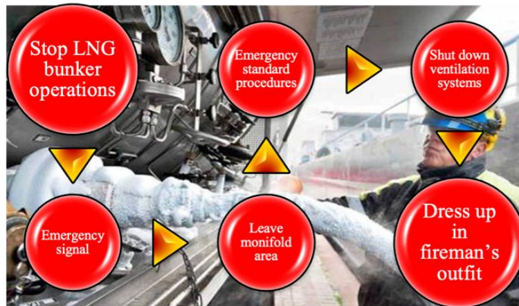
Fig. 2. Procedure in case of LNG leakage
